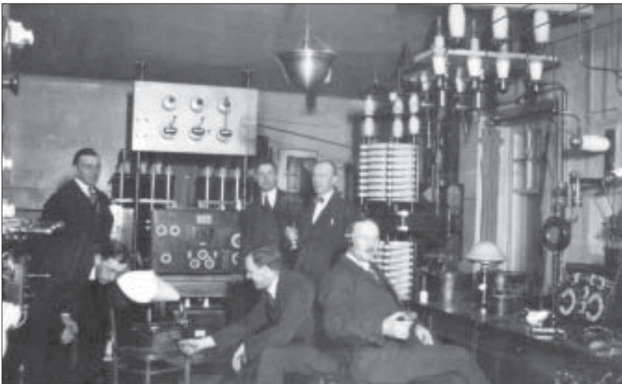
Telefunkens ingenjörer får en demonstration i musiksändning med Huth-sändaren. Grammofonens plåtratt är ersatt med en pappersstrut för att anpassa ljudstyrkan till mikrofonen.
