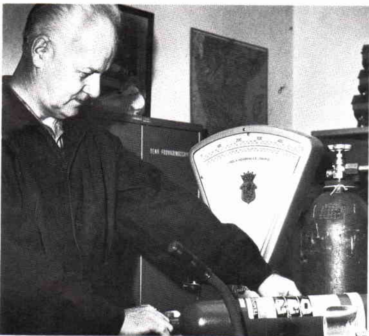
Montör Sven Johansson vid anordningen för påfyllning av kolsyresläckare.
