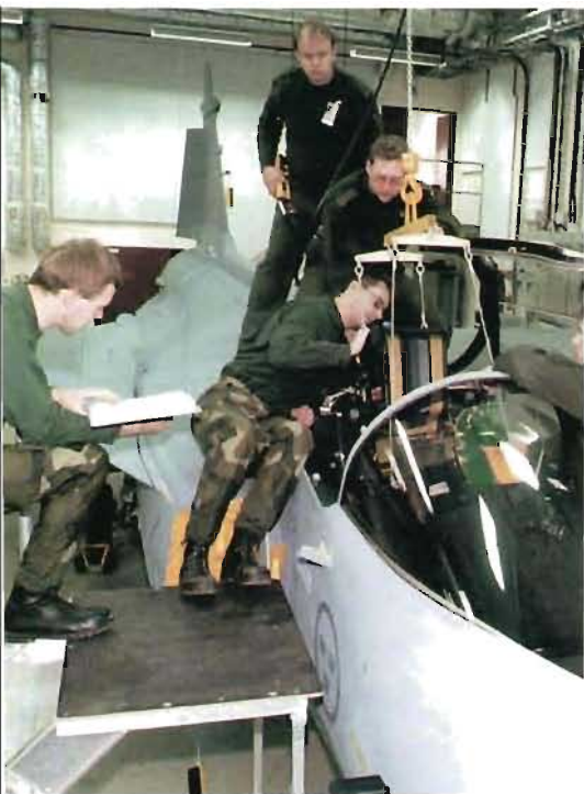
Säkerhetsystemen har hög prioritet i utbildningen, här övas montage av Gripens raketstol.
