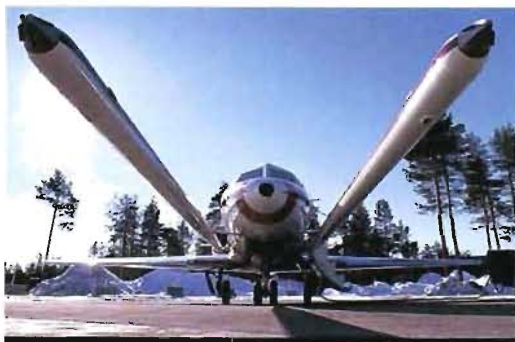
Carabas-radarn är avsedd för markmålsspaning och provades av FOA under Focus på en TP 86 Sabreliner.
