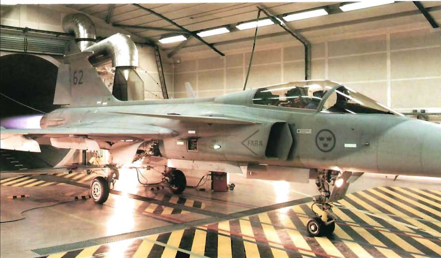
Att provköra motorn i JAS 39 är ett delmoment i utbildningen av Gripen-tekniker vid FTS, Flygtekniska skolan, i Halmstad. Bilder: Per Josse/Försvarets bildbyrå
