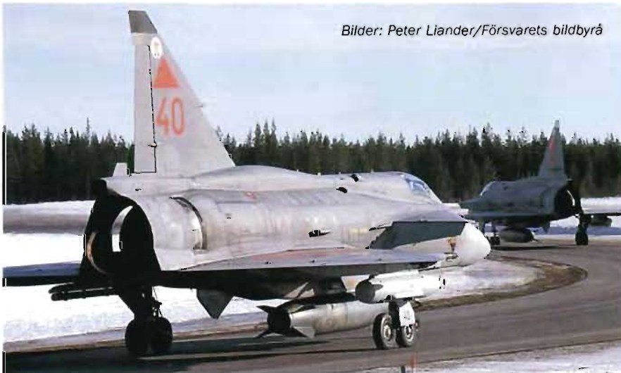
JA 37D Jaktviggen taxar ut till start. Flygplanet närmast är utrustat med motmedelkapseln U-95 under höger vinge.
