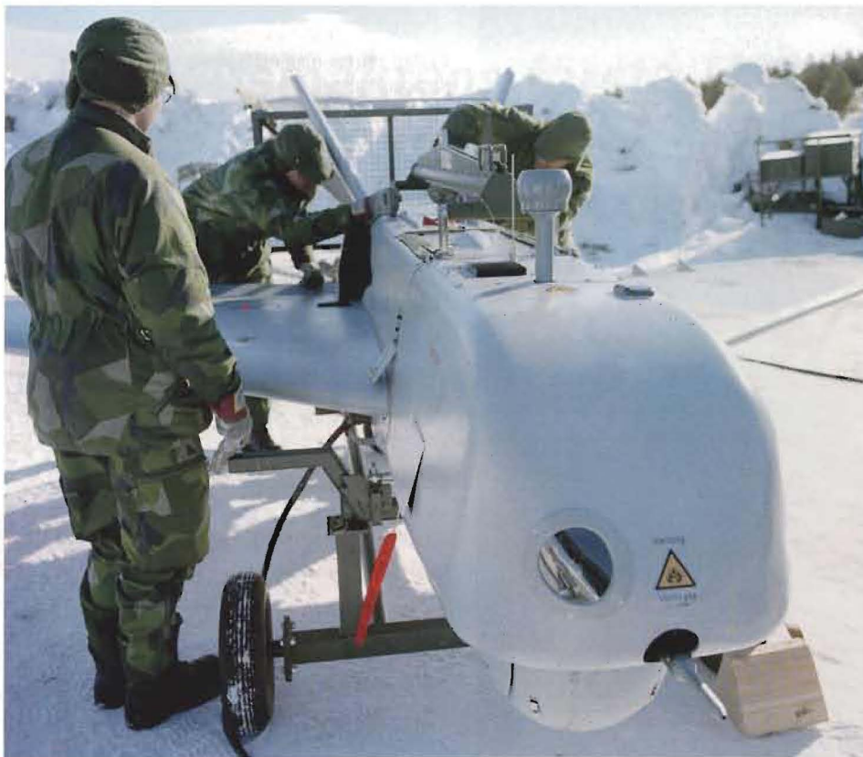
"Ögat" på Ugglans nosparti döljer en TV-kamerallins.
