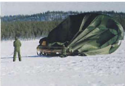
Ugglan landas med hjälp av en fallskärm. Här tas farkost och skärm om hand efter landning.
