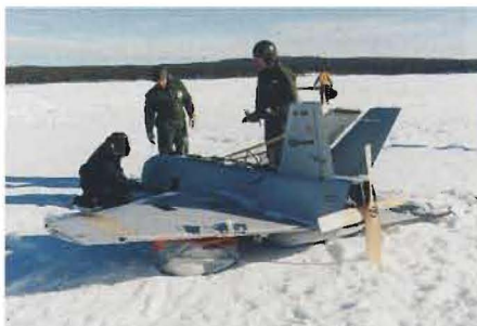
Ugglan landas med hjälp av en fallskärm. Här tas farkost och skärm om hand efter landning.
