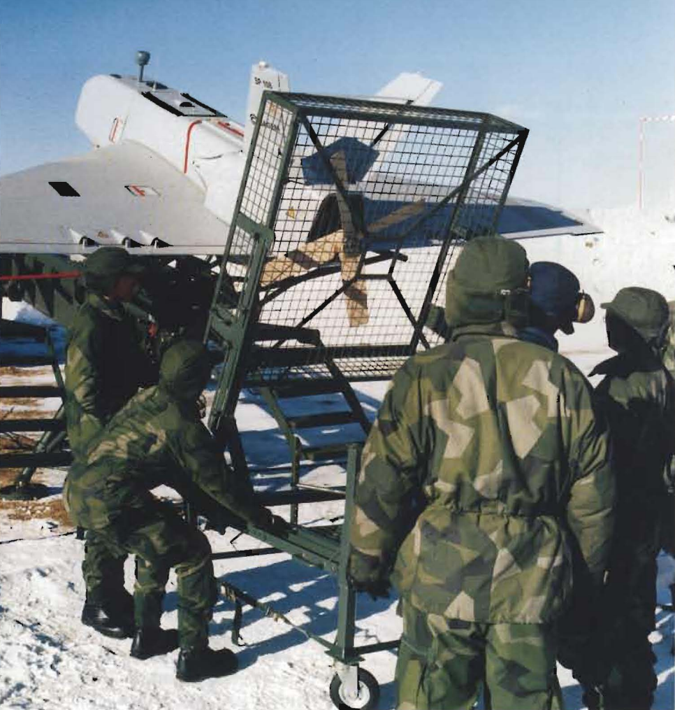
Ugglan startas med hjälp av en luftdriven katapult. Buren bakom farkosten är till för att skydda personalen från den roterande propellern.
