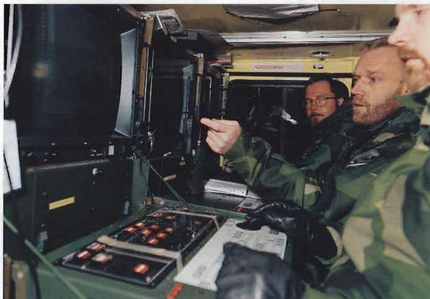
Den obemannade spaningsflygfarkosten Ugglan manövreras från en markstation. Flygrutten är förprogrammerad, men piloten kan också direktstyra farkosten från sin manöverpanel.
