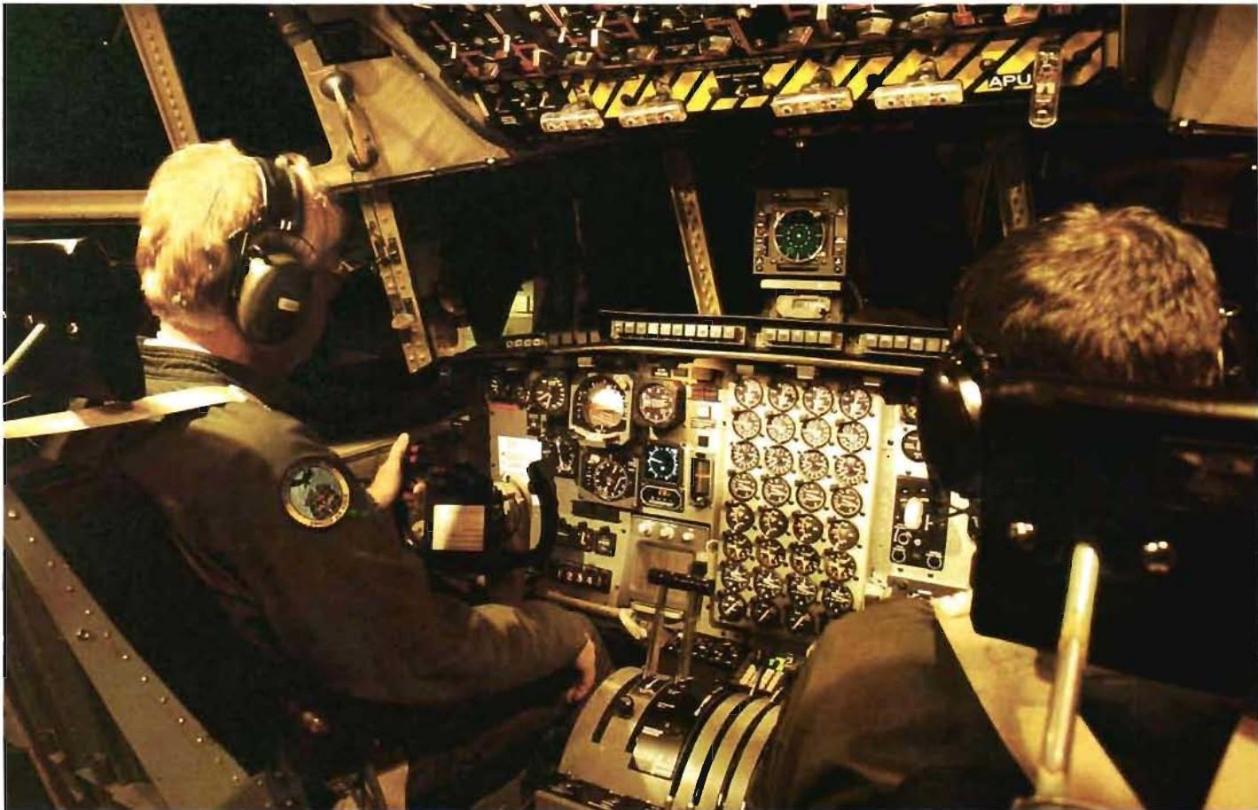
I Hercules-simulatore vid F 7 i Såtenäs kan besättningarna öva flygning i en realistisk hotmiljö och handhavandet av flygplanets motmedels- och varningssystem (VMS).
