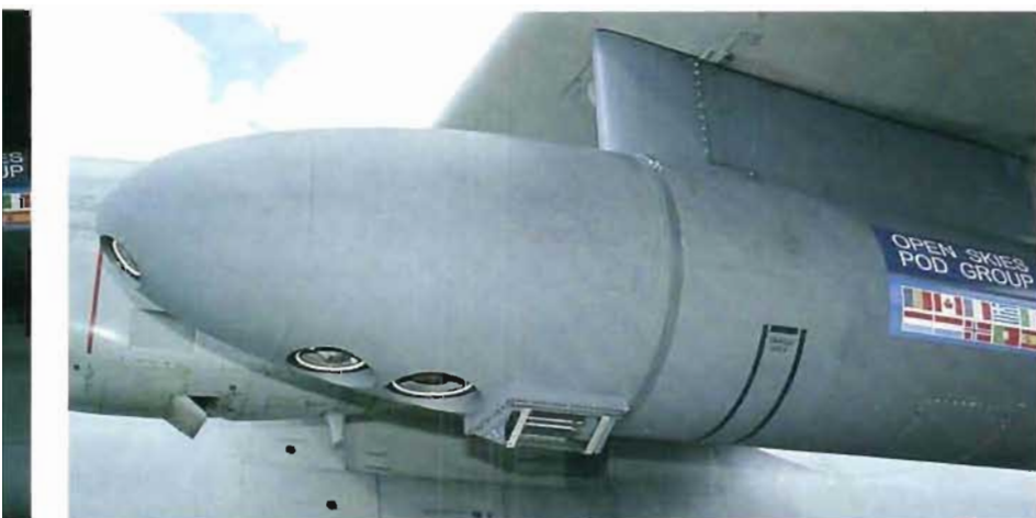
Denna kamerakapsel har specialkonstruerats för Hercules och används av tio Open Skies-länder.
