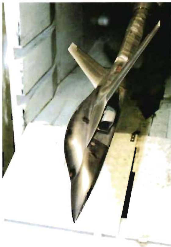
Vindtunnelmodellen av ett framtida skolflygplan testas vid FOI i Bromma.
