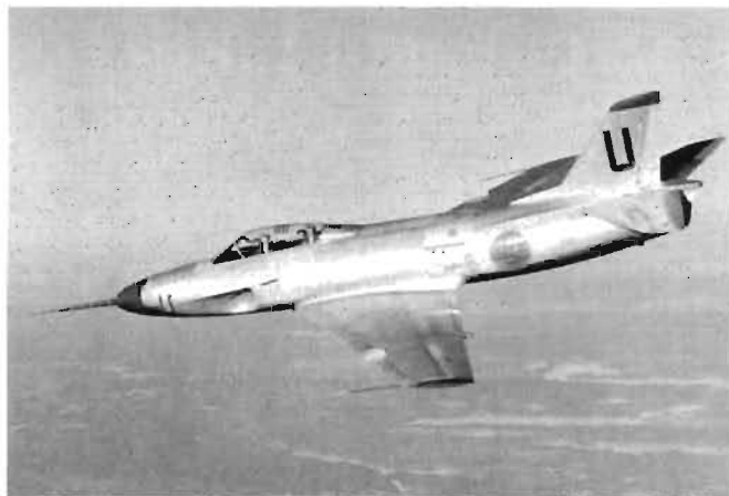
Prototypen för Saab A 32 Lansen var det första svenskbyggda flygplan som flög fortare än ljudet. Spröten i nosen är ett pitotrör för tryckmätning i ostörd luft. Men den alltid lika välinformerade dagspressen visste berätta att spröten användes för att "sticka hål" på ljudvallen. Foto: Saab
