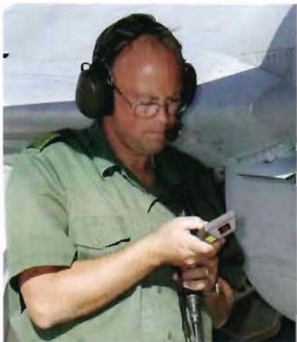
Anders Lundgren med fjärrkontrollen till Gripens servicepanel. Foto: Håkan Brandt
