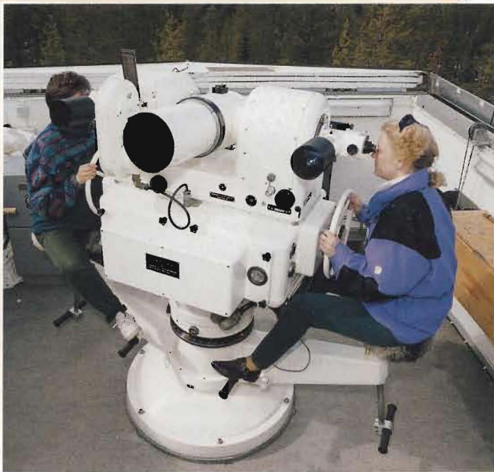
Provskjutningarna registreras med hjälp av kinoteodoliter.
