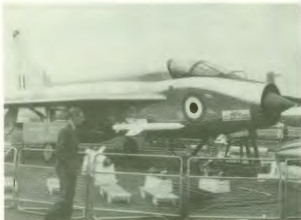
Ovan: Lightning T 4 med side-by-side-placering av lärare och elev.
