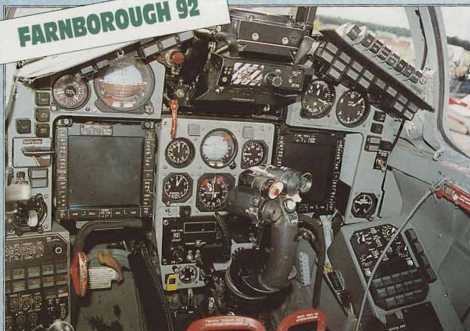
Interiörbild från MiG-29M:s cockpit. Förarutrymmet har ny instrumentering. Här ses (bl a) två fyrkantiga, identiska monitörer med elektronisk presentation = radar- och navigeringsinformation. – Foto: Ulf Hugo.
