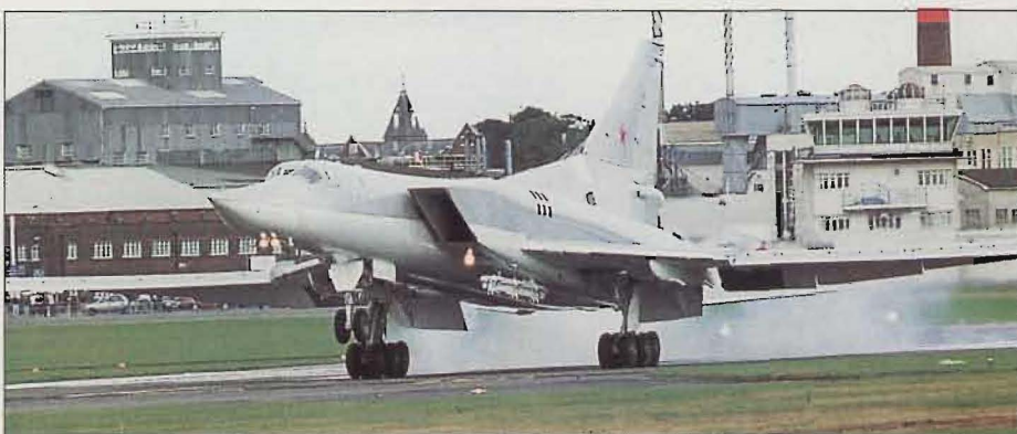
◀ Också ny för västupbliken – Tu-22M3 BACKFIRE C. Kan t ex bära 96 facklor/remspatroner. Har nu också fått robotskottvarnare, som syns som en rund "hatt" på kroppsoversidan. – Foto: Ulf Hugo.
