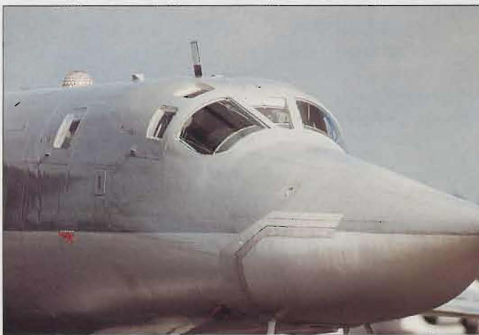
◀ Också ny för västupbliken – Tu-22M3 BACKFIRE C. Kan t ex bära 96 facklor/remspatroner. Har nu också fått robotskottvarnare, som syns som en rund "hatt" på kroppsoversidan. – Foto: Ulf Hugo.
