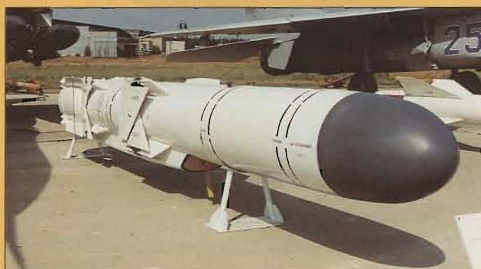
Ovan; Framför MiG-29K ligger bägge versionerna av AS-17 – närmast den signalsökande (Ch-31P) och i h versionen med aktiv radarmålsökare (Ch-31A). Östsidans första taktiska sjömålsrobot.
