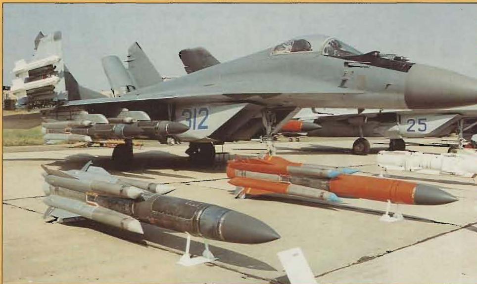
Ovan; Framför MiG-29K ligger bägge versionerna av AS-17 – närmast den signalsökande (Ch-31P) och i h versionen med aktiv radarmålsökare (Ch-31A). Östsidans första taktiska sjömålsrobot.
