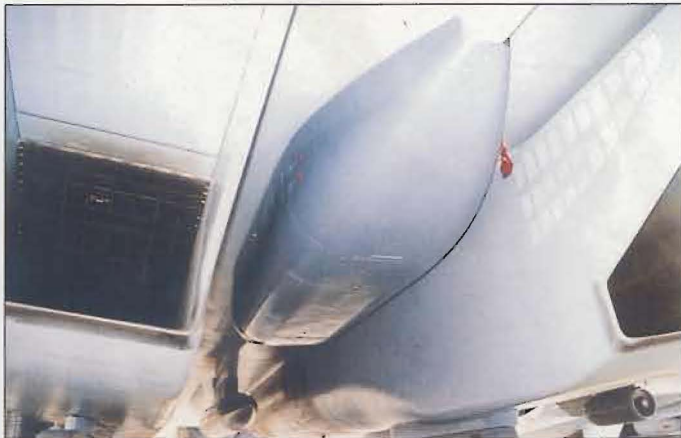
Utbyggnad mellan luftintagen för extraavionik till Su-30MK.
