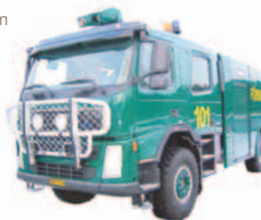
Räddningsbil Typ 1 är baserad på en Volvo FM 480 6x6 av dubbelhyttmodell, med plats för förare och fyra besättningsmän. Normalt driver räddningsbilen på sina två bakaxlar, men vid behov går även framaxeln att koppla in. Dieselmotorn på 13 liter uppfyller gällande miljökrav (Euro 4). Släckningstanken rymmer 7,4 kubikmeter vatten. Dessutom finns en tank för 225 liter skum.
