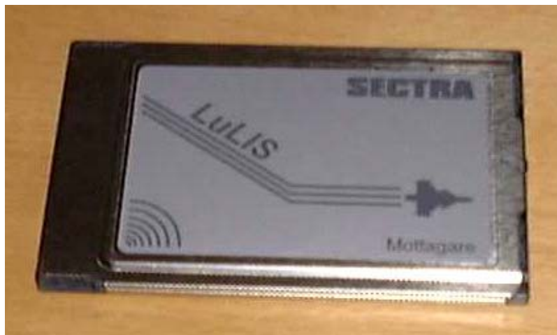
Figur 4 Lucia är benämningen på DARC-mottagaren i PCMCIA format.
