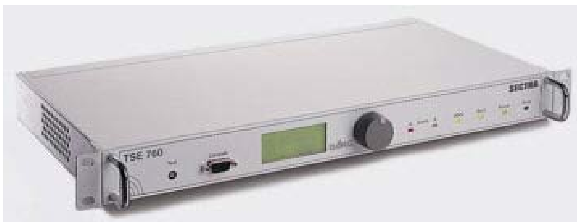
Figur 8 TSE användes för att modulera in 76 kHz underbärvågen i FM-kanalen
