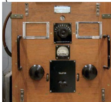
Antennenpassning i bunkerlådan Foto: Thomas Hörstedt
