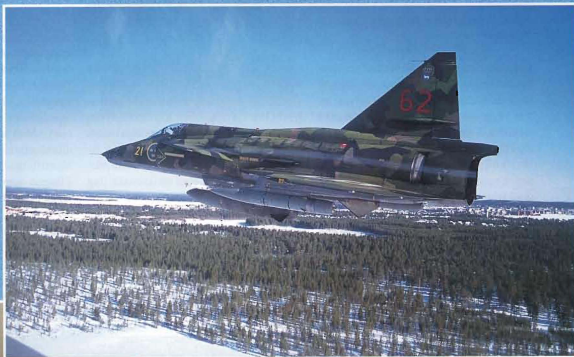
AJSF 37 Viggen utrustad med motmedel- skapslar på låg höjd under ett flygspä- ningsuppdrag.
