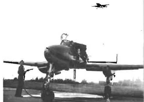
● Ovan: 1947 tillfördes F6 åter en SAAB-produkt, A 21:an — flygplanet med den "skjutande" propellern och världens första katapultstol. — Vid motorkörning på högre varv kopplades markkylväxelådan ur och spjällen öppnades, varvid vatten krävdes för kyning av motorn.
