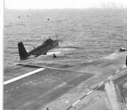
▲ Från den fartygsbaserade 16. spaningsflottillen ses ubåtsjaktflygplanet Breguet Br. 1050 Alizé dra iväg. Operationstid: Ca 5 tim. Konstruerad 1954. Besättning: 3 man. 75 A. levererades till Aéronavale 1959.
