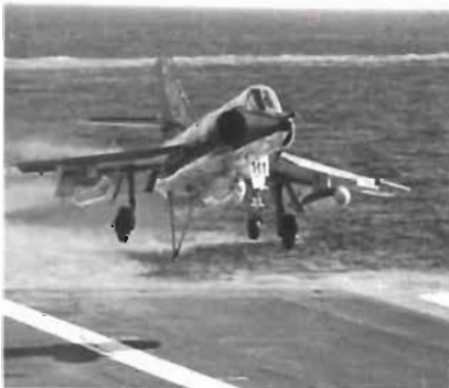
▲ Med kroken nedfärd! "I lägsta hugg" går Etendard in för landning på Foch:s däck. Ideal sättning är mellan lina 1 och 2. Fullgas vid sättning. Tas bromsvaljer 4 stannar fpl bara 5 m från däckskanten...! (Detta är lufttankningsfpl:t.) – 1978 ersätts E. med Super-Etendard.
