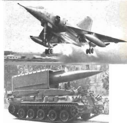
● Ovan: Den flygburna kärnvapenstyrkan utgörs av 36 Mirage 4 (16 i reserv). Här en lufttankning från KC-135F (=Boeing 707), varav 11 lär finnas i tjänst. — T h i mitten: En Mirage 4 lylter med hjälp av startraketor. Fpl flög 11g 1959 och avses aktiv in på 80-talet. — Nedan t h: Franska arméns kärn-rb 'Pluton', som avlyras från AMX-30 tanks.
