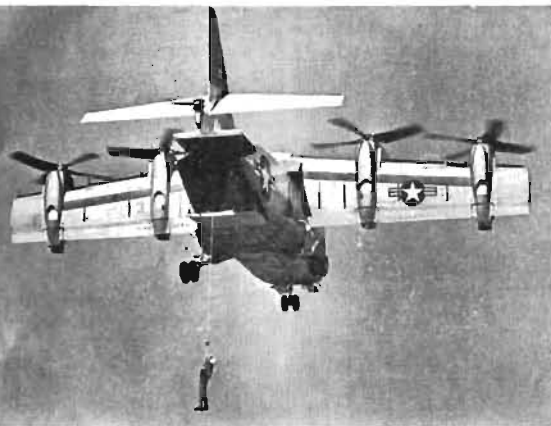
● Ovan: Ling-Temco-Vought XC-142 som (tillsammans med Canadas CL-84) är det idag enda flygande tippvingeflygplanet. Fem prototyper beställdes redan 1962. Startvikt 17 ton. Aktionsradie ca 400 km. Maxfart ca 650 km/tim.
