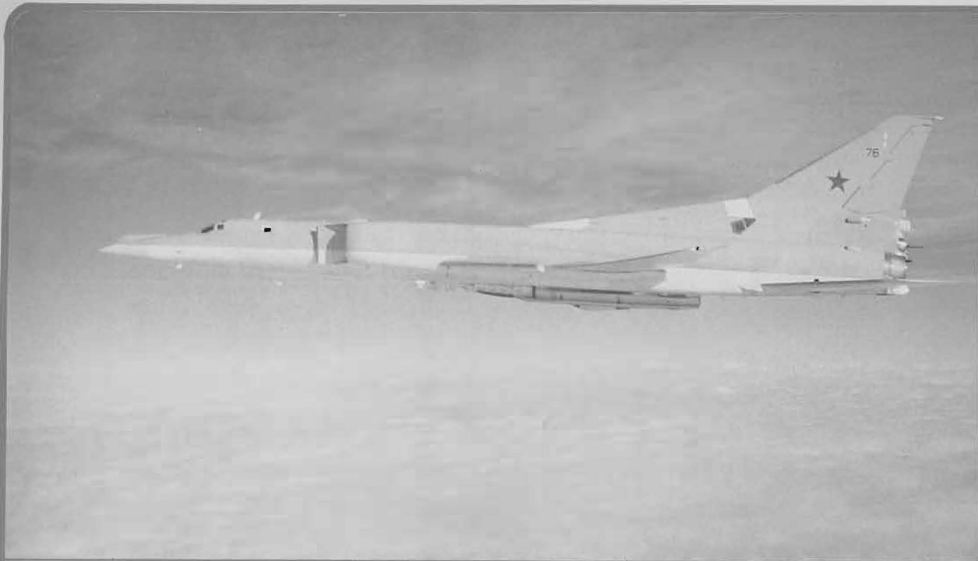
Ovan: Tu-26 'Backfire B' med attackroboten AS-4 'Kitchen'. Fpl är ur Sovjetunionens marin-flyg (AVMF).
