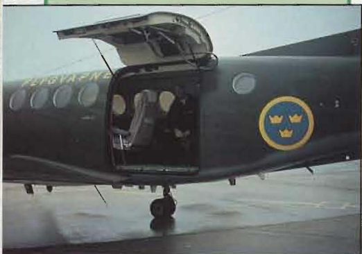
F 7:s superkung är en speciell fraktversion som har en stor lastdörr. Därmed underlättas i- & urlastning av skrymmande last.
