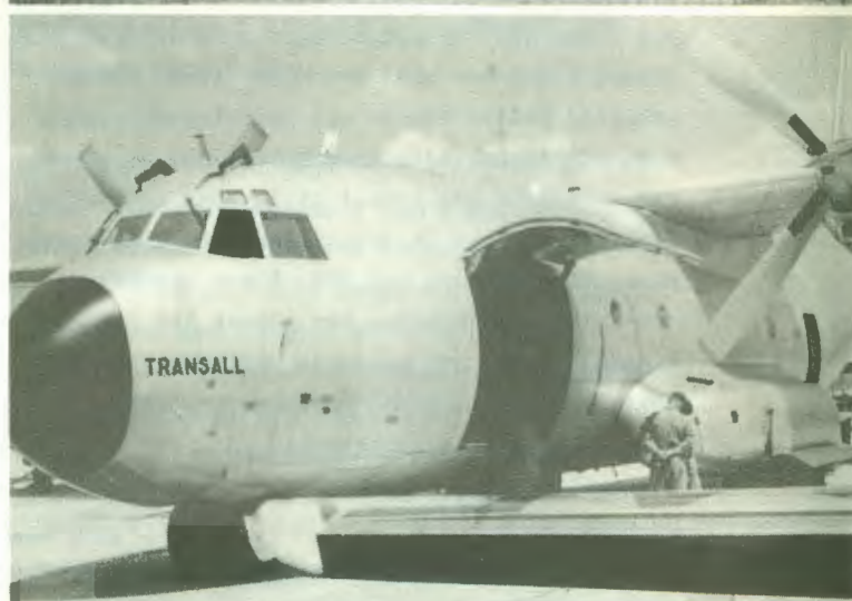
Uppifrån och ned: Mirage III-B, skolversion av det franska Mirage-jaktplanet. Spaningsplanet Grumman Mohawk. STOL-planet Breguet 941. Främre lastporten på fransk-tyska Transall.
