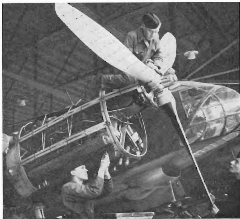
FRAN ITALIEN år 1940 nödköpta Caproni Ca 313 (S 16 och B 16) blev trogna verkstadskunder. Här tillsyn på en av de två 725 hk Isotta-Fraschini Delta-motorerna på ett dylikt plan. Flygplanets toppfart ca 440 km/tim.
