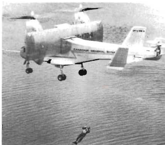
Ovan: Canadair (+General Dynamics, USA) började medio 60-talet VTOL-prov med CL-84. 3 prototyper testades, 2 förlorades. Nya prov lär vänta (för US Navy) med en större version, Sea Control Ship? — Nedan: Världskända 'vattenbombaren' CL-215 som 'brandsoldat' i såväl Canada (20) som Frankrike (10).
