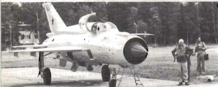
● Årets MiG-21-gästversion skiljer sig bl a från "67-versionen" genom att huven öppnas genom viking åt högersidan (och ej som tidigare uppåt-framåt). – MiG-21:ornas piloter var: Mj Grabovetskij, mj Kudrjavtsev, kn Zubéts, kn Bokátj + Il Gunjko. Kontingentschef var öv Basistov och ställföreträdare övlt Avédikov.
