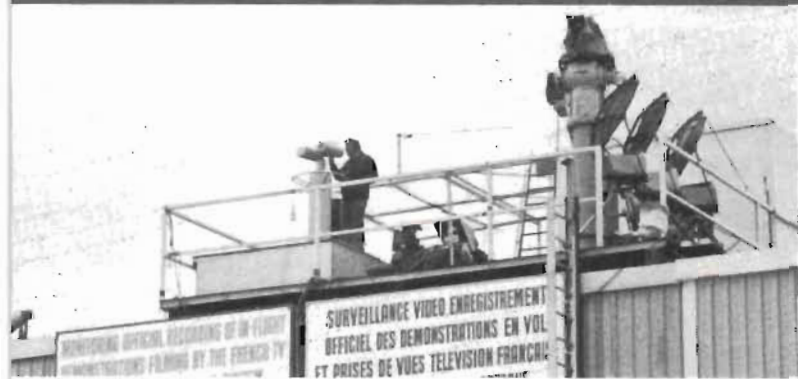
Ovan + t h: Saab-Scania automatiska TV-målsökare (TVT 300) utnyttjades av fransk TV på Le Bourget. — Nedan: Ambassadör Hägglöf och kommandör Strömbeck besöker Volvo Flygmotor och Saab-Scania. T h är C FMV-F, gen mj Olin, och statssekr i PD, Ulf Larsson, på dito besök.
