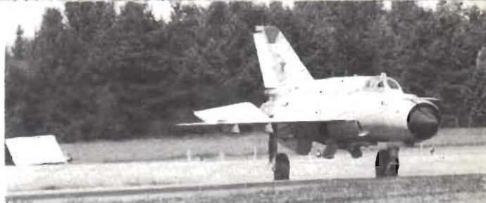
● De tre översta bilderna visar fr v. De sex ryska MiG-21 bis anländer F11, Lt Gunjko i långsam roll; 4-grp:en i gemensam start. — Närmast ovan: MiG-21:an har ingen noshjulsstyrning, vilket betyder att styrning på taxibanor o d görs med bromsning med huvudställen.
