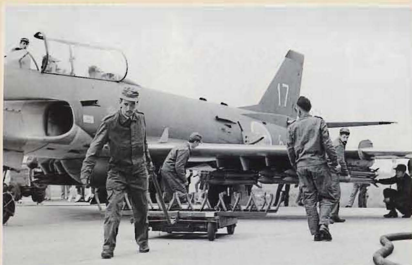
1960-talets attackflyg bestod som mest av tolv divisioner A 32A Lansen. Här avslutas lastningen av attackraketer avsedda för markmål på ett flygplan från F 6 i Karlsborg.
