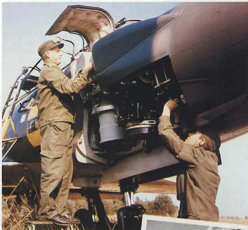
Lansens spaningsversion S 32C hade nosen fylld med kameror som gav bilder av hög kvalitet.
