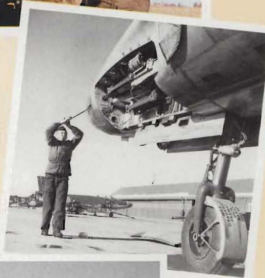
Till höger: Attackversionen A 32A var bland annat beväpnad med fyra 20 mm automatkanoner. Här servas en av dem vid F 7 i Sätenäs.
