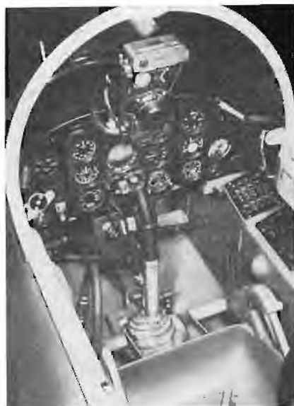
Skolflygplanets instrumentering och spakar är konventionellt placerade, enkelt och överskådligt.
