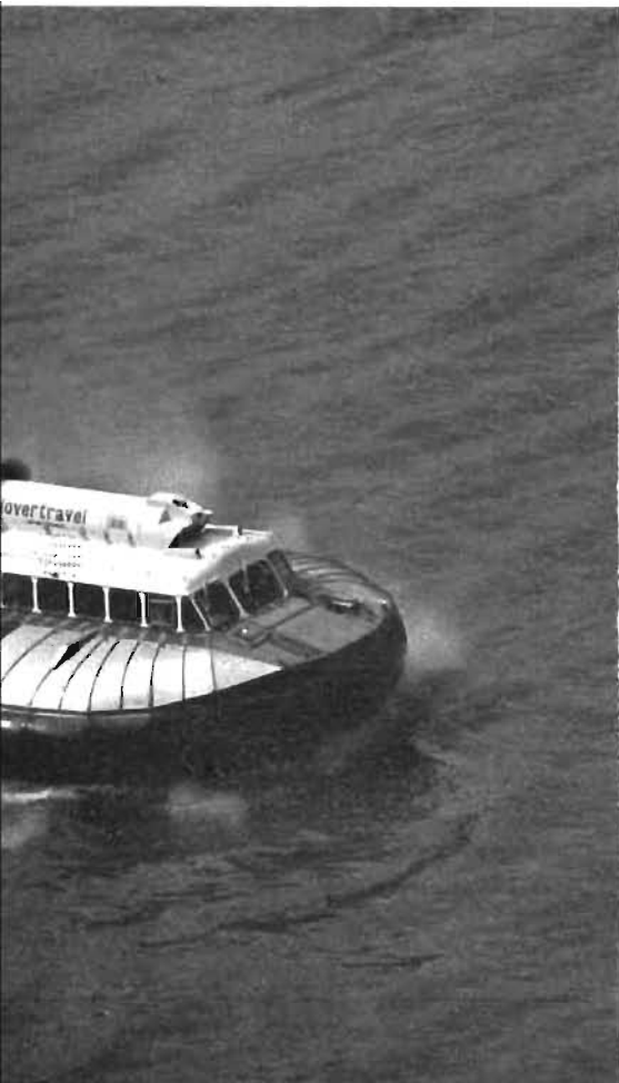
Världens hittills största svävare Westland SR.N3 om ca 37 ton. Tillhör brittiska försvaret. Grundkonstruktionen innehöll ej flexridåer men modifierades med flexridåer, som medger hindertagningsförmåga till 1,5 m. Fart: 70 knop i vindstilla. Last: 12 ton.
