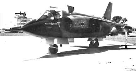
o Ovan: VAK 191 B (mockup) tysk motsvarighet till det engelska VTOL-flygplanet Harrier. Nedan: En intressant och behaglig STOL-skapelse, Robertsons konverterade Cessna 337 Super Skymaster. Tvåmotorigt (drag och påskjut) och sexsitsigt affärs/trp-flygplan som först i Europa lancerades av pumpstillverkaren Stenberg-Flygt AB. Bofagets förste pilot är Nils-Bertil Kronström — sprungen från FV.
