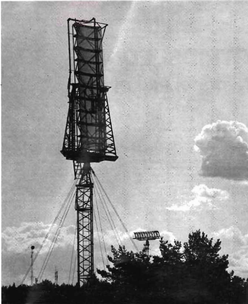
● Radarantennernas vakande ögon upptäcker det mesta i lufthavet. Här radarhöjdmätare.
