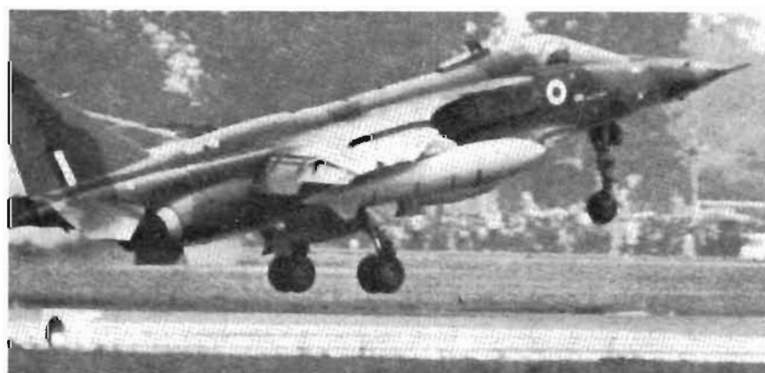
▲ Ovan: a) Prototyp S-06 av anglo-franska (BAC/Breguet) Sepecat "Jaguar" (med ryggpuckel à la Viggen) under landningsfasen — med två fälltankar och två 450 kg bomber. b) Prototyp S-07 (t:h) har testats med ny nos med laseravståndsmätare samt ett datorstyrt navigations- och siktesystem. — Motorer: Två Rolls-Royce/Turbomeca RB 172/T 260 Adour.
