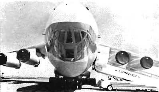
▲ Sovjets Il-76 åter klicherad, nu i enfacepose och i treplansklass. Spännvidd: 50,5 m. Längd: 46,6 m. Höjd: 14,7 m. Startvikt: 157 ton. Lastprestanda: 40 ton. Räckvidd med last: 5.000 km. Maxhöjd: 13 km. Maxfart: Ca 900 km/h. De fyra D-30 motorerna är på 12.000 kp vardera. Antal hjul: 20 (4 nos, 2x8 kropp). Kan operera från gräsält. Flygkroppen är försedd med lastramp så att i- och urlastning kan ske direkt.
