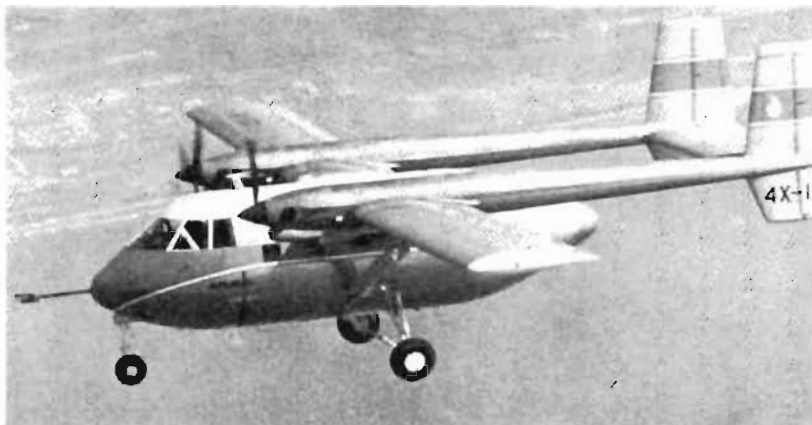
▲ Ovan: En imponerande debut gjorde Israel Aircraft Industries med sin andra prototyp av den rundnätta, lilla tp-maskinen "Arava" — 5,6 ton med maxlast. Men lastar ändå 20 passagerare eller 16 fallskärmsoldater. En verklig STOL-kärna med utmärkta manöveregenskaper och som sägs starta på ca 170 m samt landa på ca 100 — efter reversering av de två turboprop-motorerna, UACL PT 6A-27. Seriestyckepriset ca 420.000 $. Skall förutom det inländska behovet också lanseras för export. En projekterad kommande sträckt version ökar passagerarantalet till 32, utan STOL-prestanda.
