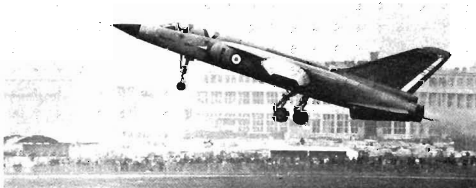
T:h: Ny för ögonen var också franska ▶ Mirage G-8 — med två turbojetmotorer (Sneema Atar 9K50) och variabel vinggeometri. Avses ersätta den enmotoriga föregångaren G-1, som därmed läggs ned. — Notabelt hos G-8:an var bl.a de teflonhinneskyddade vingarna.
