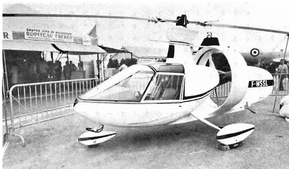
T:h: Gyroplanen blir allt populärare. ▶ Invid förfriskningsbaren sågs franska Alpväis D-2 Rabouyt, som nu undergår de inledande flygproven vid testbasen Istres. Marchfart 180 km/t med två ombord. Räckvidd: 800 km.
