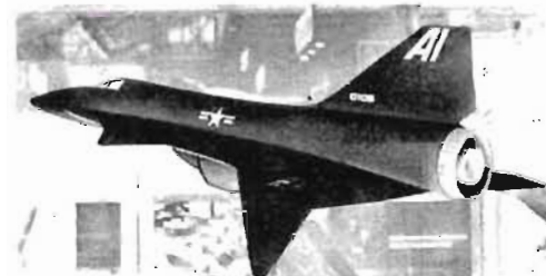
▲ Ovan: Ling-Temco-Vought:s bidrag till de amerikanska studierna av ett "high-Mach-aircraft" i M.3-klass. Förutom det enorma luftintaget under buken och de doppade vingspetsarna påminner modellen något om North Americans nu nedlagda forsknings/raketprojekt, X-15.
