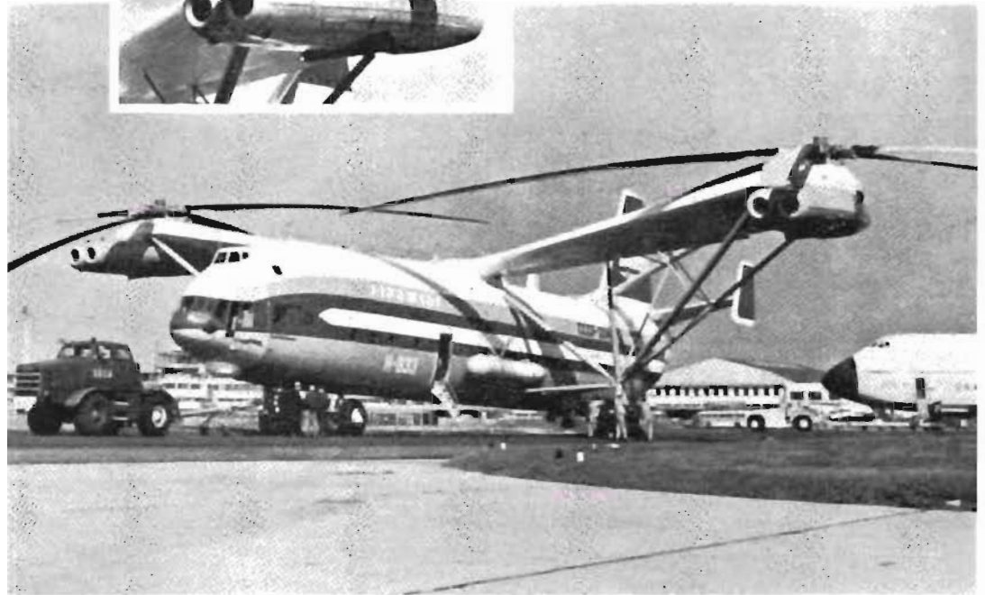
▲ Ovan: Sovjets största och längsta transporthkp MIL Mi-12 "Homer". Besättningen består av sex män. I den övre cockpiten sitter navigatör och radiooperatör. I den undre pilot, andre styrman, flygingenjör och mekaniker. Motorer: Två par Soloviev D-25 FV turboaxel. Flygkroppens längd: 37 m. Total rotorspännvidd: 67 m. Höjd: 12,5 m. Lastprestanda: 40 ton. Max flygvikt: 105 ton. Maxfart: 260 km/t. Maxstighastighet: 30 m/sek. Räckvidd: 500 km. Maxhöjd: 3.500 m. — Är utrustad med hakpåse-radar.
