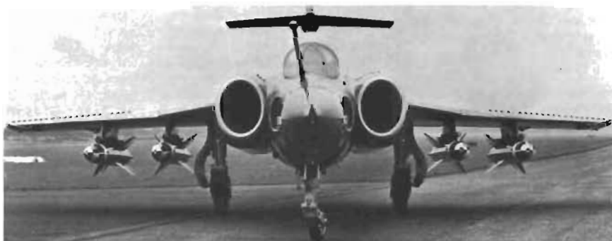
◆ En Hawker Siddeley "Buccaneer" Mk 2 utrustad med fyra brittisk-franska air-to-ground-robotar, som kan styras via TV.
