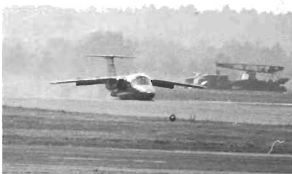
◆ Inga landställsljus ses lysa på Saabs 105 G då den snävt planerar in för landning. Det bilxtrar och röker vid buk-sättningen. Så kanar fpl på stabil kurs länge banan
