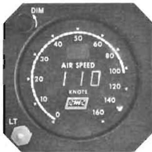
◆ Ovan och nedan: Digital presentation är ingen direkt nyhet. Det finns idag bl.a. små bärbara räknemaskiner i handeln med det utförandet. Men för flyginstrument har ej tidigare denna idé nyttjats. Nu lancerar bl.a. Marconi t.ex. sina höjd- och Mach-mätare med lysande, digital sifferpresentation. Flygsäkerhetsfrämjande vid t.ex. stressituationer.
