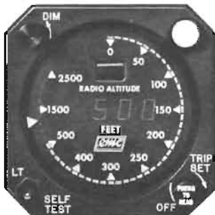
◆ Ovan och nedan: Digital presentation är ingen direkt nyhet. Det finns idag bl.a. små bärbara räknemaskiner i handeln med det utförandet. Men för flyginstrument har ej tidigare denna idé nyttjats. Nu lancerar bl.a. Marconi t.ex. sina höjd- och Mach-mätare med lysande, digital sifferpresentation. Flygsäkerhetsfrämjande vid t.ex. stressituationer.
