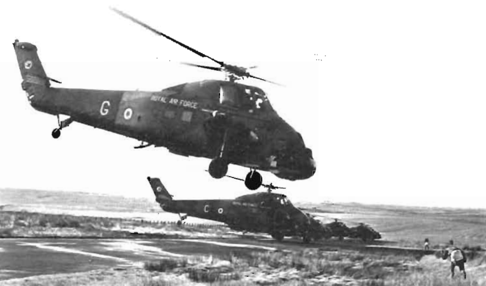
▲ Wessex Mk.2 — kan ta 16 fullt utrustade soldater eller 8 bärar och ett sjukbiträde. ● BAC Jet Provost Trainer Mk. 5 — ett skolflygplan för grundläggande flygutbildning. Denna nya version är en vidareutveckling av Mk.4 och har tryckkabin. Marschfart ca 470 km/tim. Leveranserna börjar 1969. ● Beagle Bassett CC. Mk.1 (nederst) — ett tvåmotorigt lätt förbindelsflygplan.
