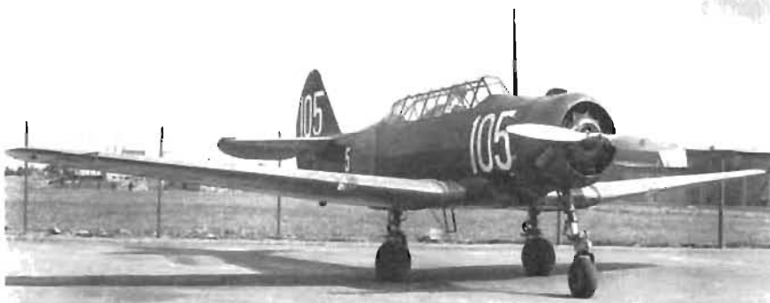
Ovan: Sk 14 var betydligt tyngre i roden än Sk 12 — men ändå mycket lättfluget. Nedan: För att vinna erfarenheter med ett noshjulförsett plan (för den kommande J 21:ans räkning) försåg SAAB en Sk 14 med fast noshjul.
