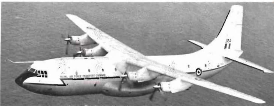
▲ Short Belfast C. Mk.1 — ett turbopropdrivet, fyrmotorigt transportflygplan för utpräglat strategiska uppgifter. Förstärkningar i lastrummet medger att tunga militära fordon fraktas över långa sträckor. Tio flygplan har beställts. ● McDonnell F-4M Phantom — avses fr o m 1968 tillsammans med P. 1127 Harrier GR. Mk.1 ersätta trotjänaren Hunter för såväl attack- som jakt- och spaningsuppgifter. Phantom tar bomber och raketer i attackversionen, medan jakten utrustas med IR-målsökande Sidewinder och radarstyrda Sparrow-robotar. I spaningsversionen ingår brittisk specialutrustning.
