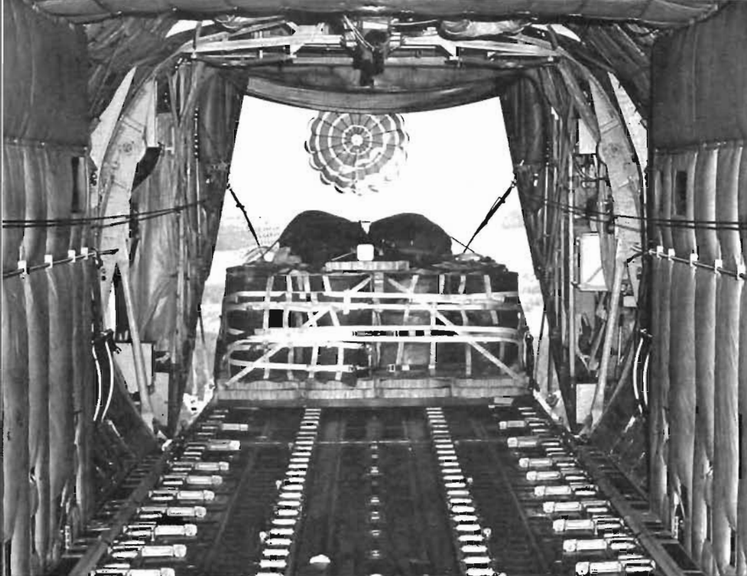
● Tv: Pansarvärnspjästerrangbil laddig för fällning. ◊ Ovan: Plattformslast med drivmedelsfat på väg ut. Observera utdragningsfall-
