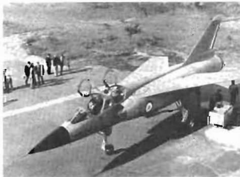
● Frankrikes Mirage G (som har påfallande likheter med sin ryska kollega "Flogger") är en enmotorig Dassaultskapelse som bygger på sina delavrigade bröders stomme. Har företagit över 50-talet provflygningar och nått 15 km höjd samt täckt ett fartområde från 180 km/tim till Mach 2,15.
