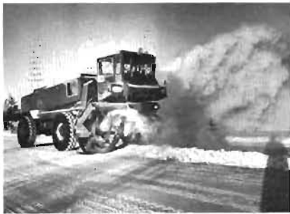
● Rolba 260 — den nya snöslungan, där föraren sitter framför snöstrålen.
