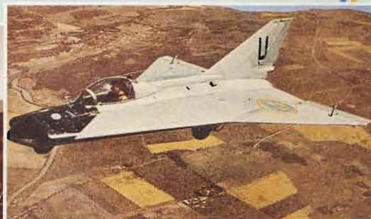
J 35 Drakens föregångare: Nedskalade "provbänken" Saab 210. Foto via Sven Stridsberg.
