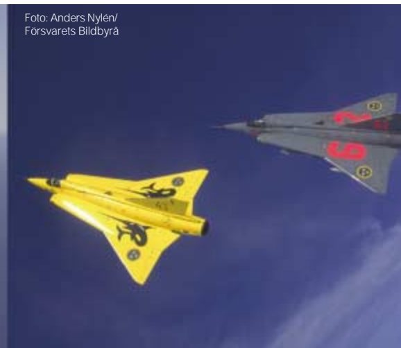
J35 Draken jungfruflyg 1955. Konstruktionen med dubbeldeltavinge fick många efterföljare, inte minst Concordeplanet.
