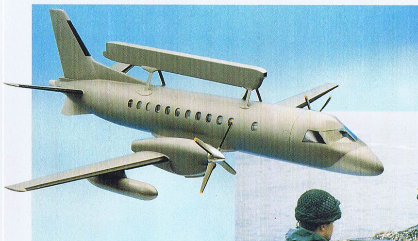
PS 890, en flygburen spaningsradar enligt ett helt nytt kostnadseffektivt koncept där små plan kan bära avancerad radarutrustning.
