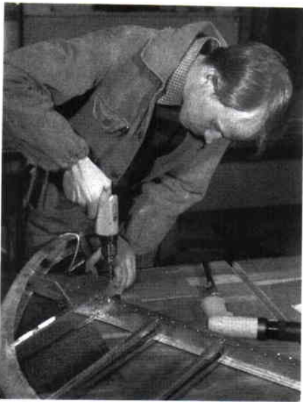
Plåtavdelningen – reparation av sidoroder.
