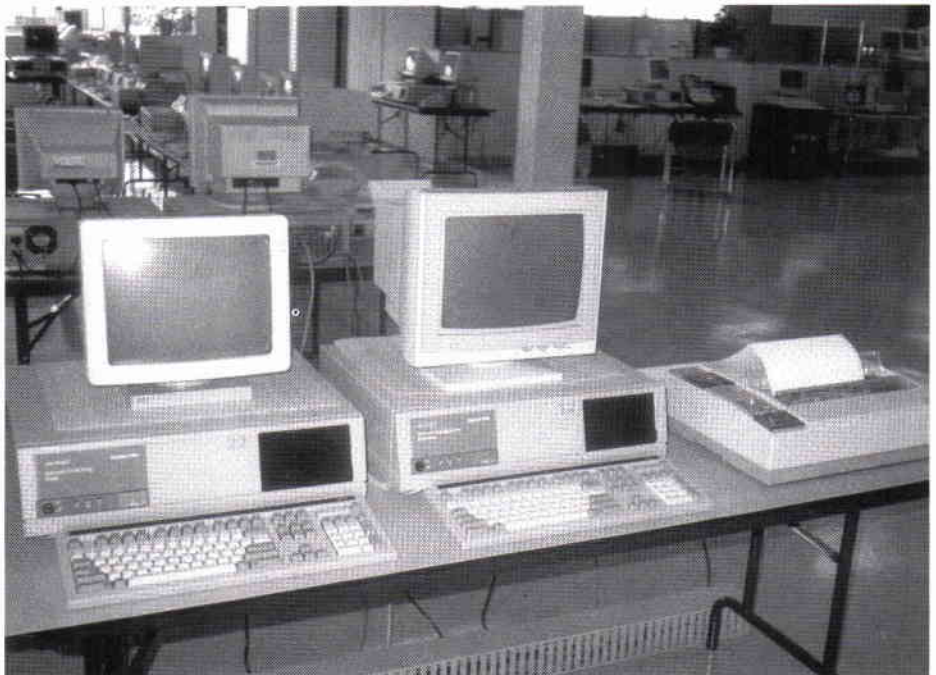
Den nya MILPAK-noden, N7000, består av två stycken WYSE PC/AT 286, en slv skärm och en färgmonitor med VGA grafik. Den vänstra utrustningen (N7400) är själva noden som ombesörjer trafiken och paketförmedlingen. Den högra utrustningen (N7900) är en så kallad NMP vilket står för Node Management Processor och den används tillsammans med skrivaren för att styra noderna och nätet.
